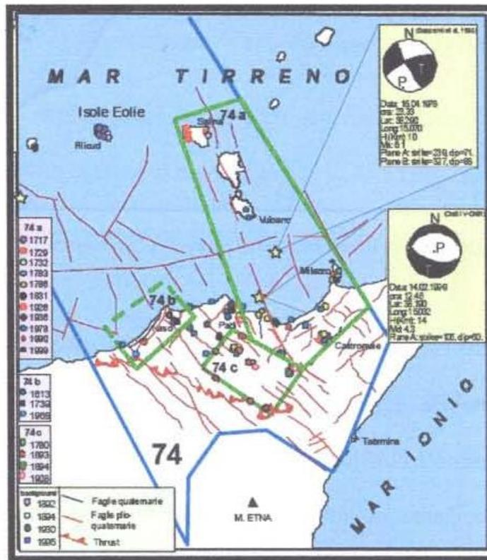
**Fig.8** Distribuzione delle intensità massime osservate dei terremoti con danno e subzone sismogenetiche individuate in Sicilia nord-orientale ( da Antichi1998) In questa modellazione Basicò ricadrebbe al limite della subzona 74c
